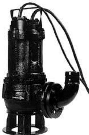
Погружной насос с одноканальным или вихревым рабочим колесом для загрязненной воды, фекальных и сточных вод, содержащих волокнистые и неабразивные частицы диаметром до 40 мм.
