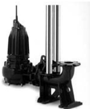
Погружной насос с рабочим колесом закрытого типа для загрязненной воды, фекальных и сточных, чистых или слегка загрязненных вод (кроме морской), содержащих волокнистые и неабразивные частицы  $d$  до 70 мм.
