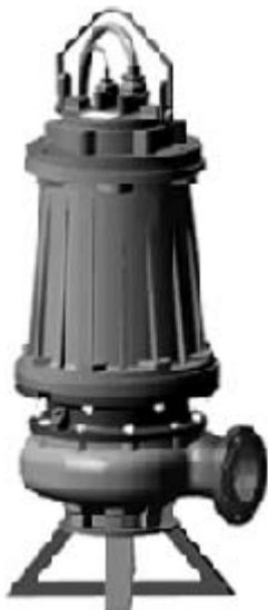
Погружной насос с рабочим колесом закрытого типа для загрязненной воды, фекальных и сточных, чистых или слегка загрязненных вод(кроме морской), содержащих волокнистые и неабразивные частицы  $d$  до 95 мм.
