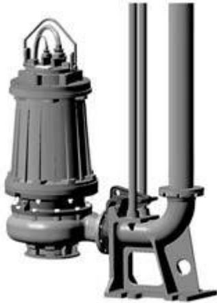
Погружной или наружный насос с рабочим колесом закрытого типа для загрязненной воды, фекальных и сточных вод, содержащих волокнистые и неабразивные частицы  $d$  до 70 мм.
