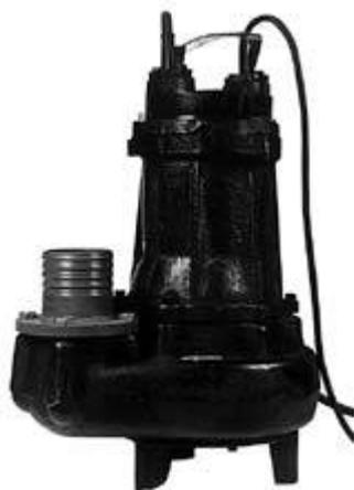
Погружной насос с одноканальным или вихревым рабочим колесом для загрязнённой воды, фекальных и сточных вод, содержащих волокнистые и неабразивные частицы  $d$  до 40мм.
